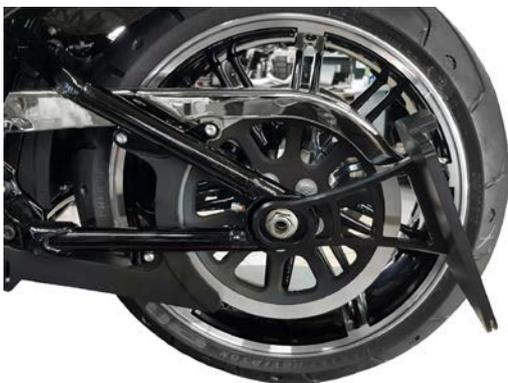
Sicherungsclip, Achsmutter und Beilagscheibe am Motorrad entnehmen.
